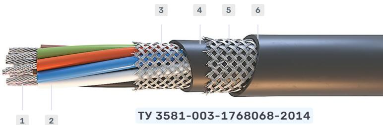
**КОНСТРУКЦИЯ**1. **Токопроводящая жила** медная лужёная многогриволочная2. **Изоляция** соответствует материалу оболочки**Скрутка** пучковая ( $N \times S$ , где N – количество жил, S – сечение жил)3. **Общий экран** в виде оплетки из медных луженых проволок4. **Внутренняя оболочка** соответствует материалу оболочки5. **Броня** в виде оплетки стальными оцинкованными проволоками6. **Оболочка:**
